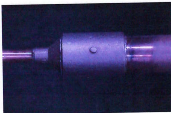
Figura 8.3 Detalhes de montagem: conector redutor de tubulação
