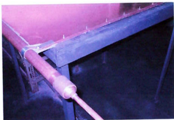
Figura 8.3 Detalhes de montagem: conector redutor de tubulação
